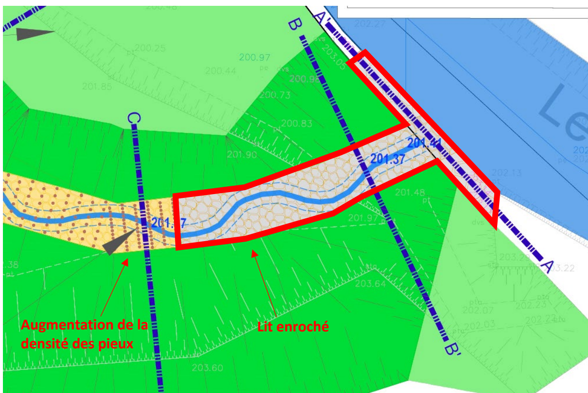
Figure 3-3 : Vue de la partie amont enrochée
